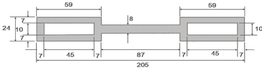
**Especimen de ensayo: Tipo I moldeado con el compuesto plástico que se solicita en la producción de la asa.**
