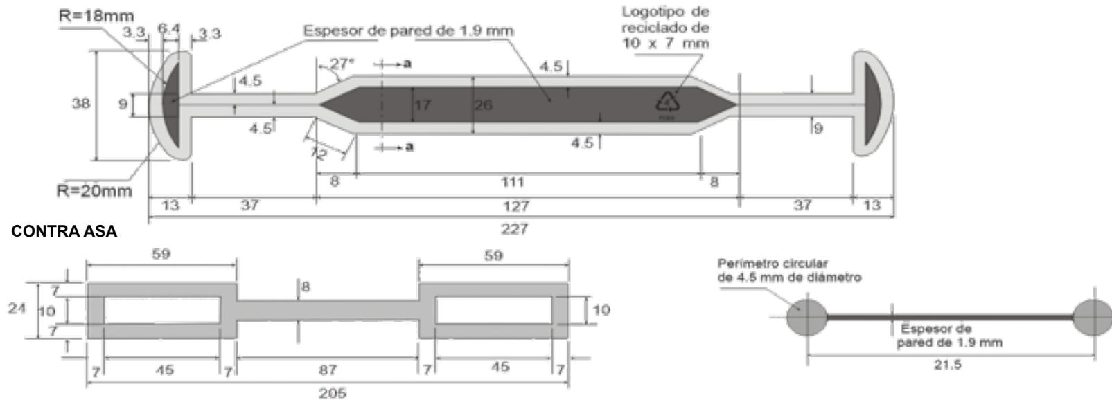
**ESPÉCIMEN DE ENSAYO: Tipo I moldeado con el compuesto plástico que se solicita en la producción de la asa**
