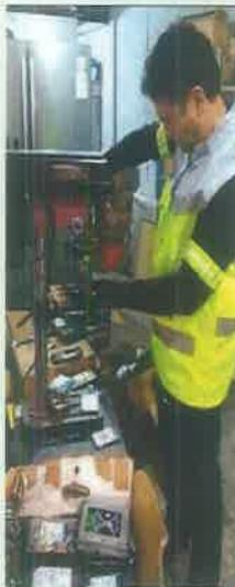
La unidad de almacenamiento se coloca sobre la placa del taladro de banco, se baja la palanca para realizar la perforación correspondiente y dejar inutilizable la misma.
